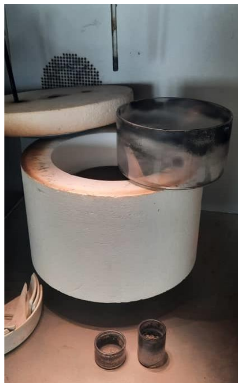
Enceinte de pyrolyse
